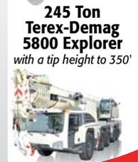
**245 Ton Terex-Demag 5800 Explorer**
